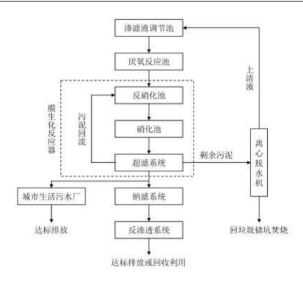
渗滤液通过厌氧反应,将大分子有机物、难降解的有机物被降解为小分子及 易降解的有机物,之后进入膜生化反应系统。该系统包括反硝化系统、硝化系统 和超滤系统。该系统可以在比传统活性污泥法更短的水力停留时间内达到更好的 去除效果,减小了膜生化反应器体积,提高了生化反应效率,因此在提高系统处 理能力和提高出水水质方面表现出较大的优势。垃圾渗滤液经上述工艺处理达标 后纳入城市污水处理厂集中处理或者直接回收利用。
