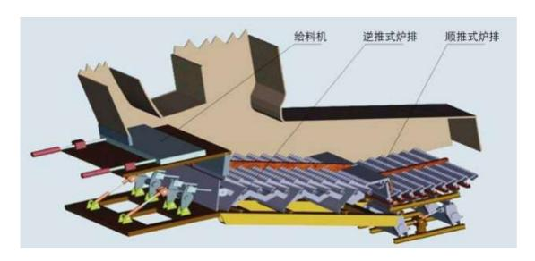
公司的二段往复式多列生活垃圾焚烧炉由逆推炉排和顺推炉排组合而成。逆 推炉排向下倾斜,而顺推炉排为水平布置。垃圾由给料机推入床面,垃圾在逆推 炉排上作翻动、搅拌和破碎而达到充分的燃烧,基本燃尽的垃圾经过一段落差进 入顺推炉排继续翻动燃烧,直至垃圾中可燃物燃尽而排出炉体。
